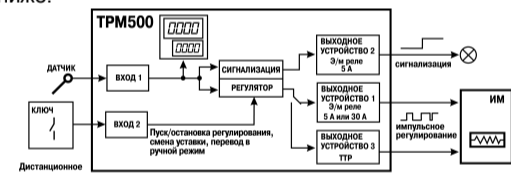
Рисунок 4 – Функциональная схема прибора
